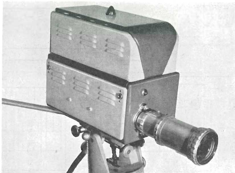
La telecamera vidicon fornisce una immagine molto dettagliata e ben contrastata.
